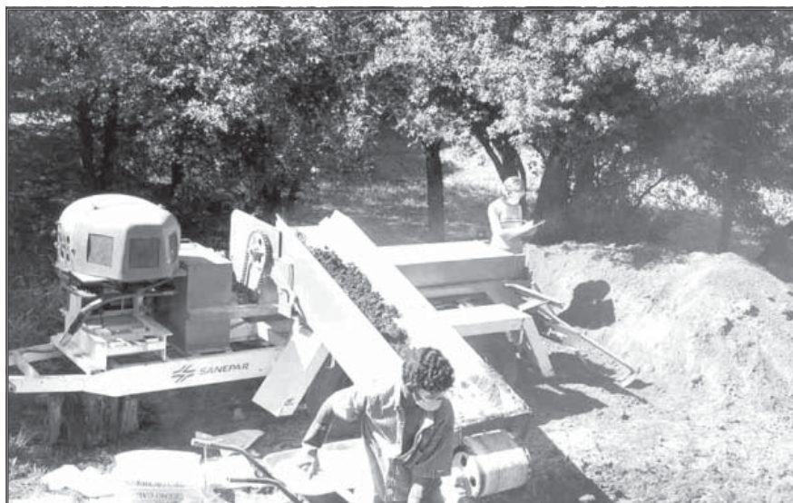
Figura 4.2 Imagem do misturador, efetuando a mistura de cal e lodo.
